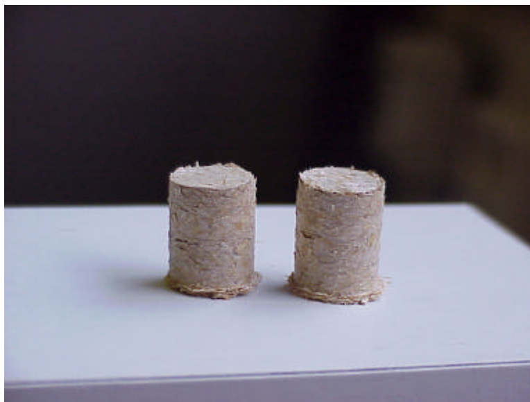
Figuras 6 y 7. Prensa manual utilizada en el laboratorio para fabricar pelets de paja de cereales. Pelets de paja de cebada, preparados para su posterior ensayo.
