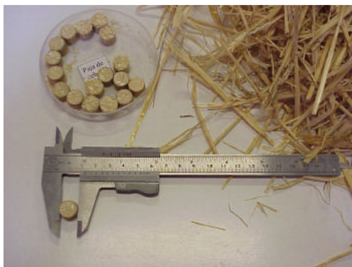
Figura 9. Medición de la densidad: medición con calibre de 0,01 cm de precisión del diámetro del pélet.
