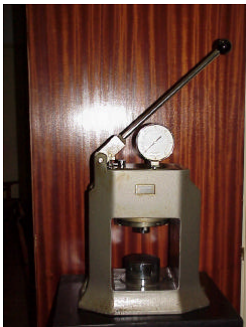
Figuras 6 y 7. Prensa manual utilizada en el laboratorio para fabricar pelets de paja de cereales. Pelets de paja de cebada, preparados para su posterior ensayo.
