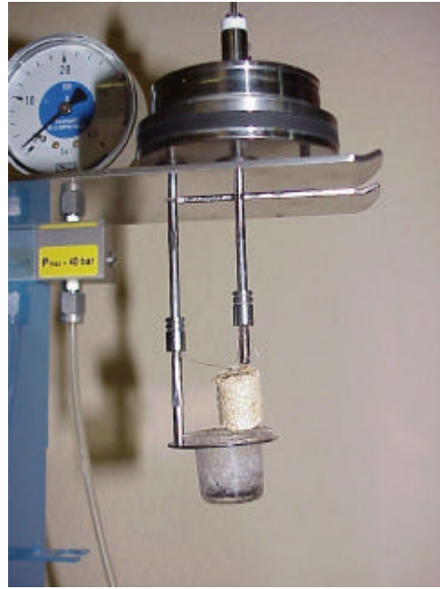
Figura 10. Medición del poder calorífico. Preparación de probeta para ser introducida en bomba calorimétrica adiabática IKA C-4000 y obtener su poder calorífico superior.
